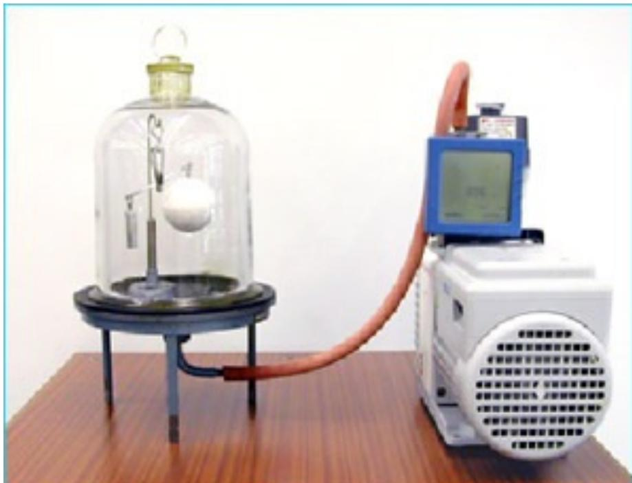
**Baroscope** : Lorsque l'on fait le vide la boule en polystyrène
